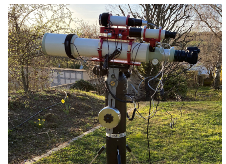
Abb. 2: Das vom Autor verwendete Teleskop mit der Fotoausrüstung auf einer azimutalen Montierung.
