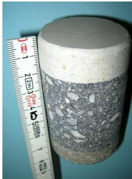
Abbildung 6 Bohrkernentnahme fertige Beschichtung
